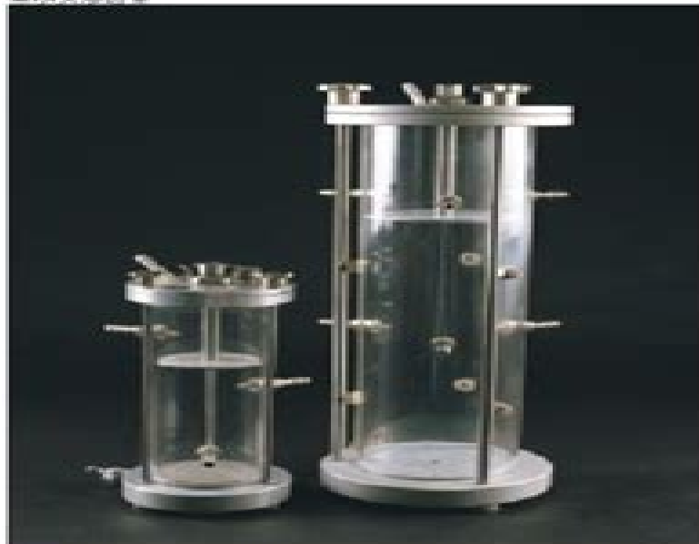
常水头渗透室
