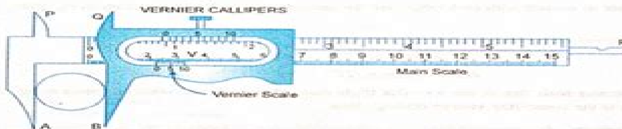
Fig. 1(a).1. Vernier Callipers
