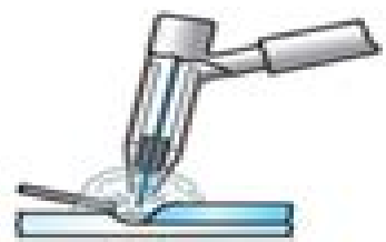
Gas-tungsten arc welding
